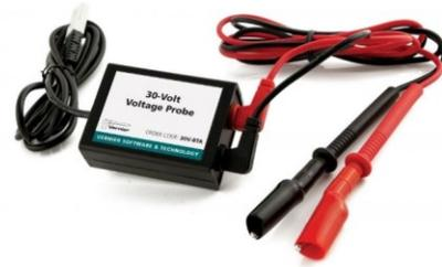
30 V 高電壓感應器通常用來量測範圍 30 V 至 -30 V 之電壓。此感應器使用  $\pm 10$  V 的輸入端介面連接至內部的分壓器。在實驗中，若涉及到超過 10 V 的電壓，便可使用此款感應器，例如：量測大型太陽能板的工作電壓。
