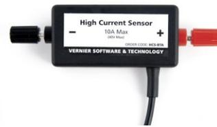
此高電流感應器可被用於量測範圍  $-10\text{ A}$  至  $+10\text{ A}$  之電流，感應器使用一霍爾效應晶片，所以不需要在電路中加入一個電阻，在霍爾晶片上覆蓋一個金屬屏蔽，以減少外部磁場的影響，一個可更換的保險絲被用來保護設備裝置和電路，在實驗中，高電流感應器用於量測大於  $1\text{ A}$  的電流，例如：太陽能電池、手持發電機等等。
