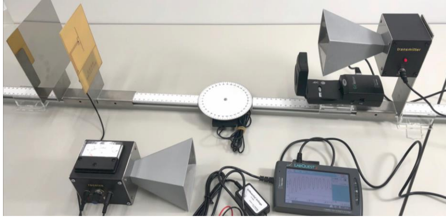
圖七 數位化微波實驗組裝說明圖
