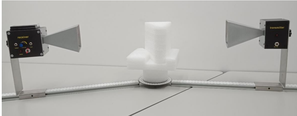
圖四 微波折射實驗架設圖
