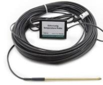
該感應器用於遠程、室外溫度的感應或用於測量湖泊和小溪在不同深度的溫度。它有一根 30 公尺 (100 英尺) 的電纜。特長溫度探棒的典型運用包括：
