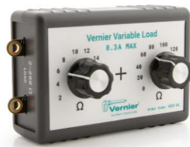
圖1 威尼爾可變電阻 (VES-VL)；最終串聯電阻為兩旋鈕數值之和 (2–200 \Omega ，最大 0.3 A)
