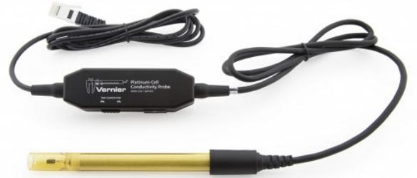
「抗酸鹼鉑材質導電度計」可在野外或在實驗室中，測量水性和非水性樣品溶液的「導電度」或總離子濃度。它具有「環氧基體」和「鉑電極」，所以能在粗糙物體上提供最佳精確度。此儀器原本並非應用在辨識特定離子，但它卻可迅速測量出樣品中離子的總濃度，因此可以用來執行各種測試實驗，有效確定「總和溶解離子」的濃度：
