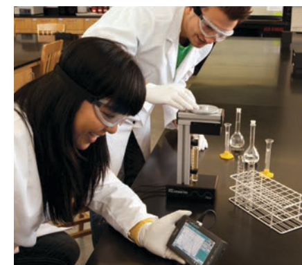
學生使用化學旋光儀及LabQuest 2，分析蔗糖的旋光效應。
