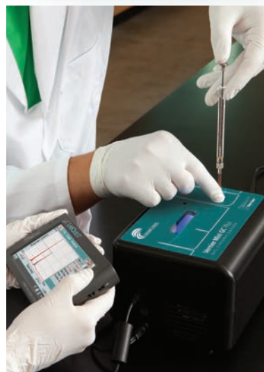
學生以簡易氣相層析儀2代及LabQuest 2分析酮類
