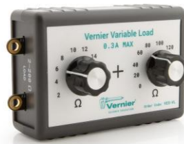
圖1 威尼爾可變電阻 (VES-VL)；最終串聯電阻為兩旋鈕數值之和 (2–200 Ω，最大 0.3 A)
