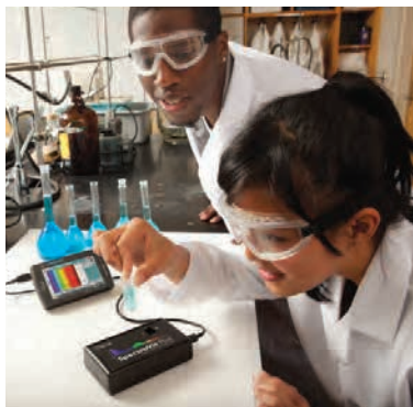
使用分光光度計(加強版)和LabQuest 2 來研究硫酸銅
