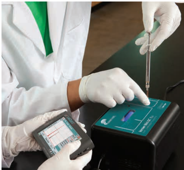
學生以簡易氣相層析儀2代及LabQuest2分析酮類
