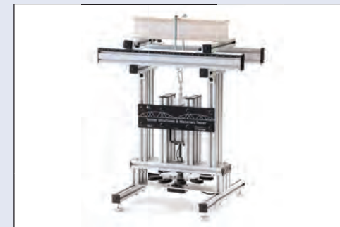
VSMT索具套件提供多種選擇來固定結構體
