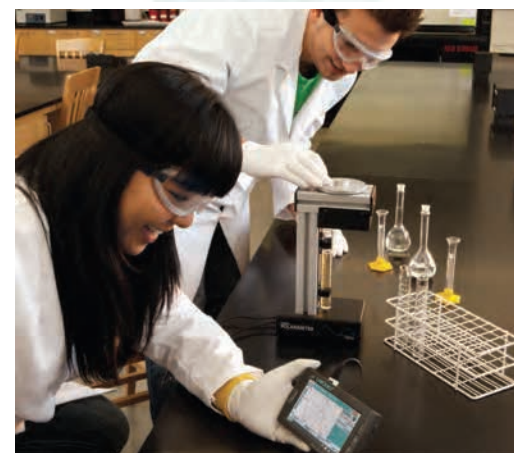
學生使用化學旋光儀及LabQuest2(資料分析收集器2)，分析蔗糖的旋光效應。
