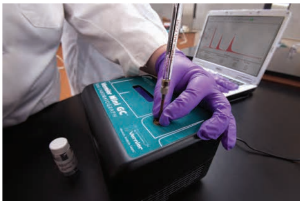
使用威尼爾簡易氣相層析儀分析酮類
