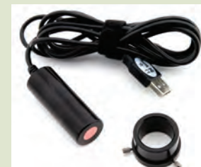
成像儀將替代原顯微鏡的目鏡並直接連接到你電腦或Chromebook的USB埠
