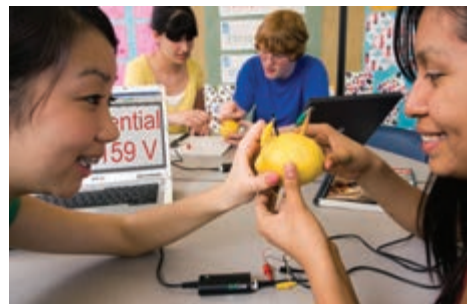
在Vernier中學實驗手冊中的“水果電池實驗”
