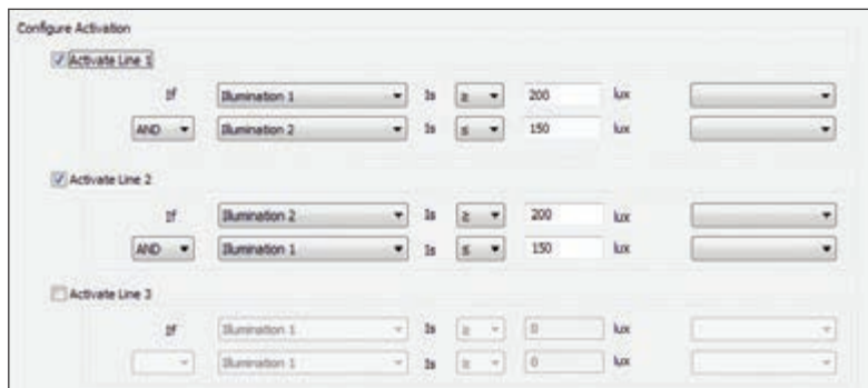
使用Logger Pro的數位輸出功能來設定輸出邏輯
