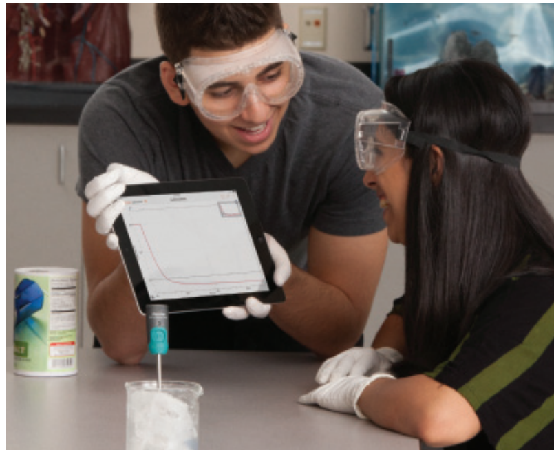
使用無線溫度感應器來調查凝固點下降
