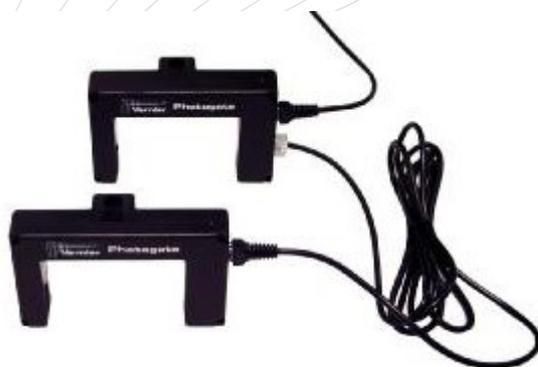
注意在一般的碰撞實驗中，兩個物體會通過兩個光柵，有時兩個光柵被擋的時間會重疊，在這個情況下，你一定要將光柵連接在平台兩個獨立的通道。如果連鎖連接模式的光柵之間的距離相同，可使用運動時間模式。在軟體中輸入光柵之間的距離來計算一個物體穿過一系列光柵的位移、速度、和加速度。
