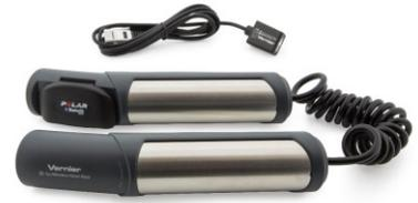
手握式心跳監控器測量人的心律，是通過記錄每次人的心臟收縮時人的皮膚表面的微小電子信號。通過插入在手握式心跳監控器手柄上的電極來測量這個皮膚表面信號。通過繪畫這個信號，心律可以被確定。以下顯示的是一個範例圖：
