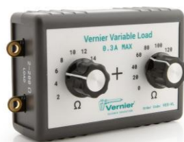
รูปที่ 2. ตัวต้านทานปรับค่าได้ Vernier Variable Load (VES-VL); ความต้านทานอนุกรมสุดท้ายคือผลรวมของค่าจากปุ่มปรับทั้งสอง (2–200 \Omega , สูงสุด 0.3 A)
