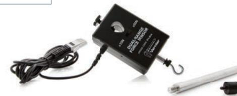
雙範圍力學感應器是一個通用測量力的儀器，它可以代替一般的手提彈簧計或安裝在一個環形支架。也可以安裝在動力小車來研究碰撞。它能測量拉力和推力。很小的力如0.01牛頓至很大的力如50牛頓都可以測量。
