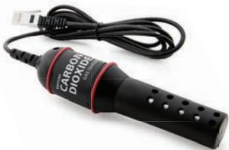
此感應器可量測氣態二氧化碳，可設定兩個範圍 - 0 到 10,000ppm 和 0 到100,000ppm。在較低的範圍內提供了更為敏感的細胞呼吸和光合作用代謝之研究。在較高的範圍探索在運動狀態中人類呼吸造成二氧化碳之變化。
