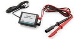
此感應器適用於量測-30到30V之電壓，此感應器在實驗中可量測超過10V之電壓，如大型之太陽能板，因為此感應器能量測較大之範圍，故此精準度將比電壓差異感應器(DVP-BTA)還要低，需依照您的實驗需求來選擇。
