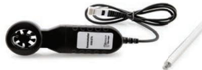
威尼爾風速計採用渦輪式，並可量測風速從0.5到30 m/s (1 到 67 mph)，其大小剛好能以手握住後在任何室外進行量測，一個標準鎖孔在其後面，而其所附之桿子能讓您們在風洞中固定，或是在風扇前進行風渦流實驗。
