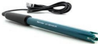
使用pH感應器就像使用傳統pH計一樣，具有自動數據收集、繪圖和數據分析的優點。放大器與pH電極為一體成型之設計。
