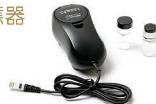
濁度感應器可用作測量淡水或海水樣品的NTU值(濁度單位，此為大多數水質收集機構和組織所使用的標準單位)，其小巧，設計到可簡易的設定，讓你可以很容易地在室外或教室內收集數據。除了水質的研究外，它也可以被用於監測在化學和生物類的沉澱物之形成或藻類和酵母種群。濁度感應器包括高品質的Hach StablCal 100 NTC標準液可快速校正和高品質的玻璃試驗瓶來儲存水質樣本。
