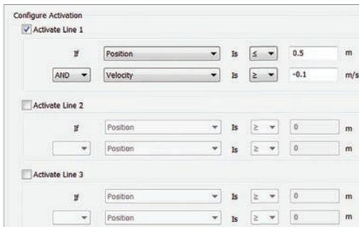
在Logger Pro中建立邏輯敘述以打開DCU線路1，當位置測量值小於 0.5 公尺"和"流速測量值大於 -0.1 公尺/秒
