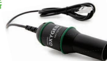
氧氣感應器可量測空氣中氧氣含量，量測範圍(0到27%)可用於研究人類和細胞呼吸。使用氧氣感應器搭配二氧化碳感應器來進行許多實驗。包含一支250 mL試驗瓶可做為研究鐵生鏽過程或是做為呼吸腔室來監控植物和昆蟲。
