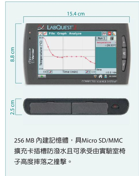
256 MB 內建記憶體，具Micro SD/MMC擴充卡插槽防潑水且可承受由實驗室椅子高度摔落之撞擊。
