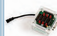
使用DCU、光感應器來追蹤光來源方向
