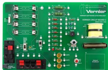
Vernier電路板2是為了用於研究簡單電路而設計的。這塊電路板本身包含電阻器、電容器、LED、開關、電池夾、外部電源連接、可復位保險絲、其他零件的連接端子，以及便於鱷魚夾測試線連接的端子測試點。
