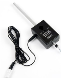
加入鉤後可以連接繩子來測量拉力
